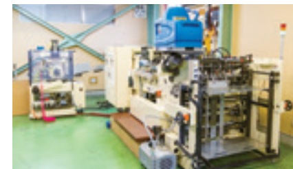
ペーパー管(紙製管)製造機
